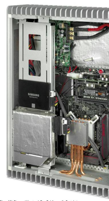
Oben: Mit Sinn und Verstand: Das Gehäuse, alle Festplattenträger (im Bild die Samsung-SSD für das Windows-10-IoT-Betriebssystem) wie auch das CD-SN250-Laufwerk von Teac werden aufwendig mit Alubutyl bedämpft, um Gehäuseschwingungen zu minimieren. Für weitere mechanische Beruhigung sorgen gelentkoppelte Absorberfüße von Thixar
