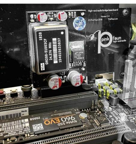
Oben/Links: Um die Daten auf stabilstem und kürzestem Wege von der SSD zu den Digitalausgängen zu transportieren, ließ Genuin Audio sich eine spezielle PCIe-Bridge bauen. Für deren Entwicklung und Fertigung zeichnen die niederländischen Digitalaudioexperten von Pink Faun verantwortlich. Der hochpräzise, extrem temperaturstabile OCXO-Taktgeber – ebenfalls von Pink Faun – trägt zur Jitter-Vermeidung bei
