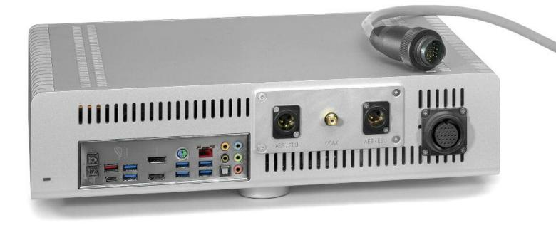
befindende PCIe-Bridge ist zudem mit einem supergenauen OCXO-Taktgeber ausgestattet, der ebenfalls von Pink Faun für Genuin Audio entwickelt wurde und laut Hersteller eine außerordentliche Temperaturstabilität aufweist. Mit beiden Maßnahmen will man den Jitter auf ein absolutes Minimum reduzieren.
