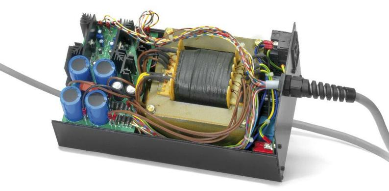
Zur Vermeidung hochfrequenter Störungen setzt Genuin Audio auf ein ausgelagertes, massiv überdimensioniertes Netzteil mit einem riesigen Philberth-Transformator. Dieser soll extrem streuungsarm sein und ausreichend Siebung entwickeln, um jeder einzelnen Sektion des Servers "sauberen" Strom zur Verfügung zu stellen
